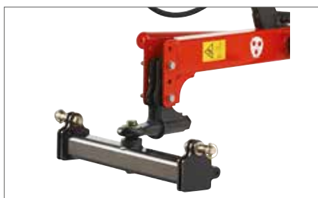
A comprida barra de tração facilita rebocar a empacotadora lateralmente com tratores largos e maiores
