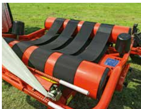
Quatro correias sem fim espaçadas uniformemente
