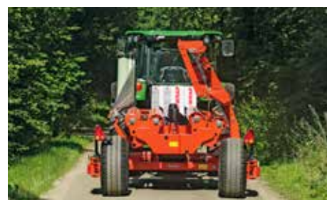
Para o transporte rodoviário, as rodas podem ser dobradas para dentro para reduzir a largura de transporte. Dobramento hidráulica é opcional
