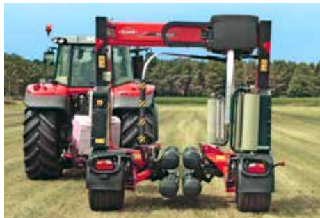
A empacotadora desdobra de sua posição de transporte de 2,5 m para sua posição de terreno de 4 m
