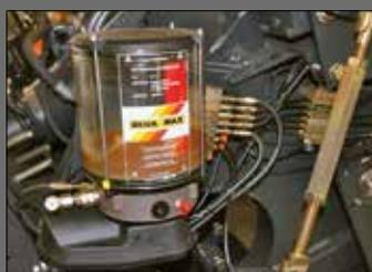
Sistema de lubrificação automático
