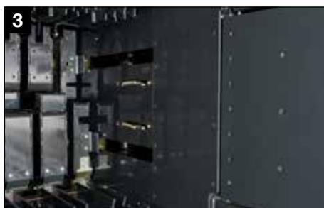
Peças do canal do fardo altamente resistentes ao desgaste e substituíveis.
