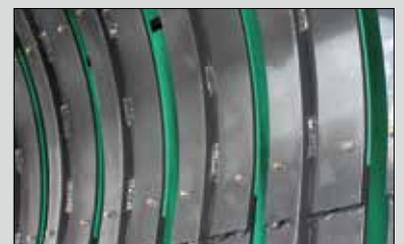
Placas de fluxo fácil para a pré-câmara
