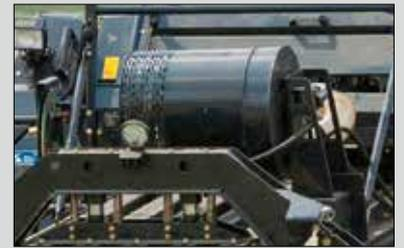
Ventilador turbo com acionamento hidráulico
