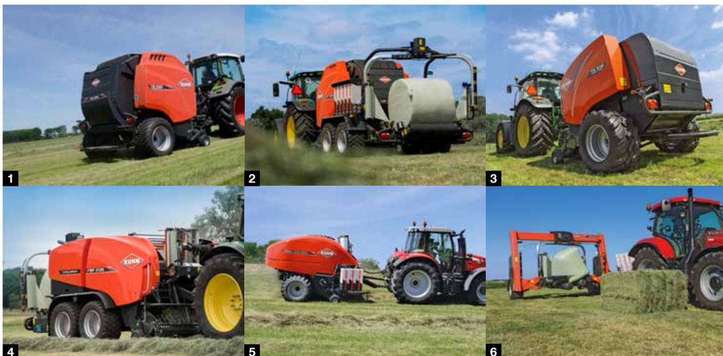
1. Enfardadoras de Câmara Variável - 2. Enfardadoras e Empacotadoras de Câmara Variável - 3. Enfardadoras de Câmara Fixa - 4. Enfardadoras e Empacotadoras de Câmara Fixa - 5. i-BIO+ - 6. Empacotadoras de Fardos Cilíndricos e Prismáticos.
