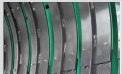
Placas de fluxo fácil para a pré-câmara
