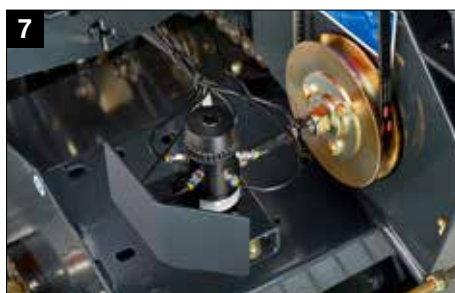
Sistema de lubrificação contínua de corrente BEKA-MAX
