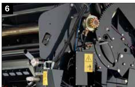
Válvula proporcional para controle de densidade na cabine
