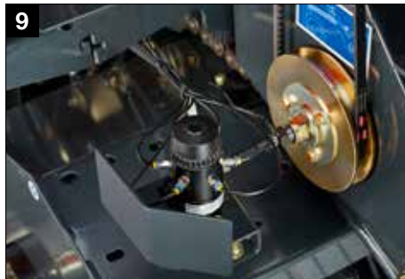
9 Sistema de lubrificação contínua de corrente BEKA-MAX
