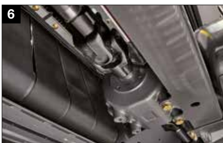
6 Junções de cardã e cruzetas reforçadas nos eixos de acionamento
