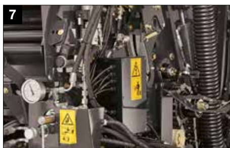
7 Válvula proporcional para controle de densidade na cabine
