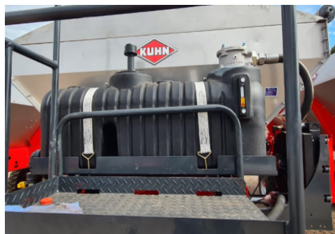
Reservatório de óleo
