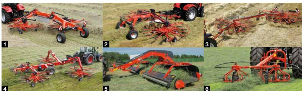
1. Enleiradores de rotor duplo semimontados com deposição lateral
