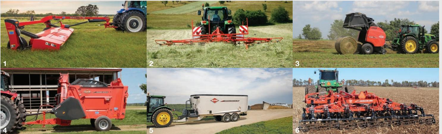
1. Segadoras - 2. Espalhador de forragem - 3. Enfardadoras de fardos cilíndricos - 4. Processadores de fardos - 5. Misturadores TMR - 6. Preparo primário do solo
