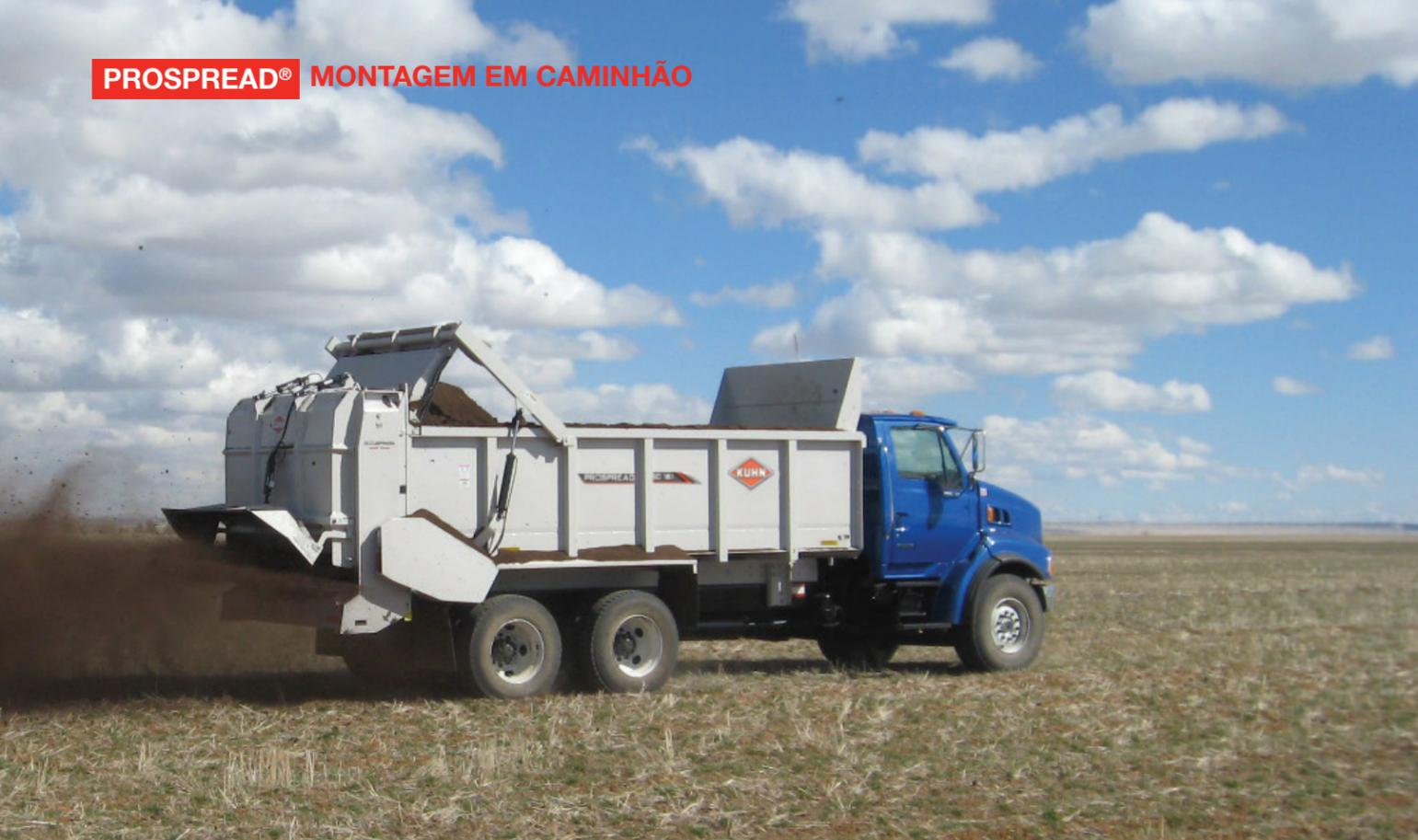
A Kuhn América do Norte oferece várias opções de distribuidor com montagem em caminhão, inclusive os modelos PSC e PXL. As opções para caminhão são adequadas em muitas operações que exigem amplos deslocamentos rodoviários, assim como nos espalhamentos de alta frequência realizados em solo firme. Esta opção permite que o operador se desloque rapidamente entre o local de carregamento e o campo.
